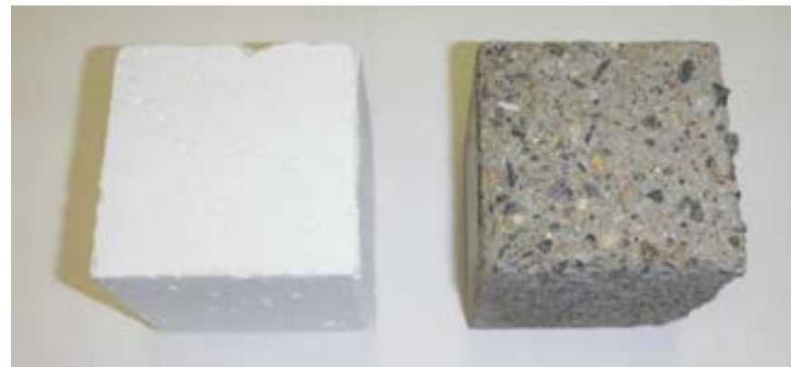
Фото 5. Внешний вид образцов после 5 циклов испытаний на морозостойкость.
