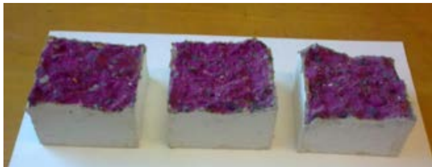
Фото 12. Внешний вид бетонных образцов с системой покрытия Elastocolor Paint после 7 суток испытаний
