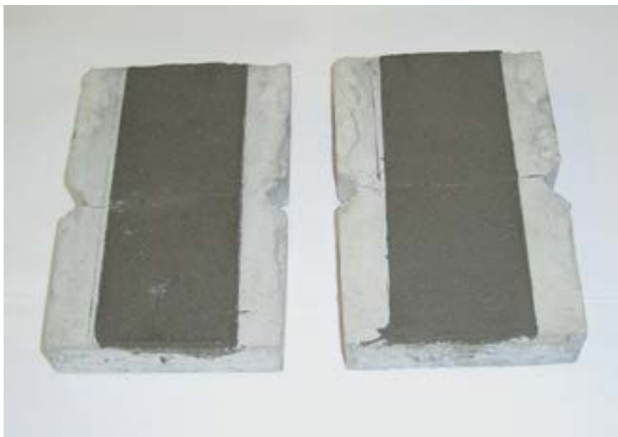
Фото 5. Внешний вид образцов бетона с покрытием для испытаний на трещиностойкость.
