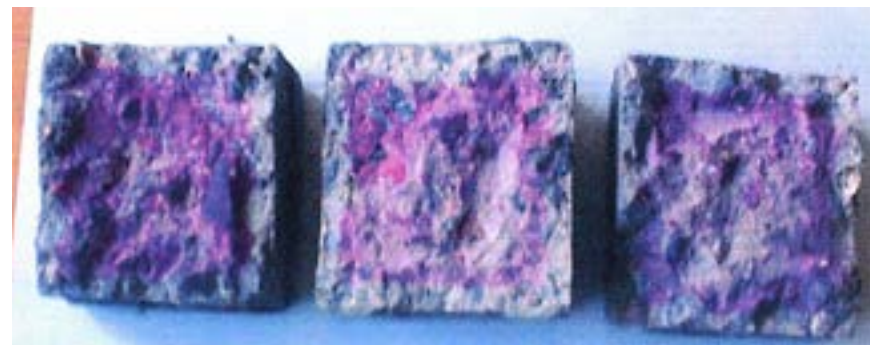
Фото 12. Внешний вид бетонных образцов с системой покрытия на основе гидроизоляционного состава Idrosilex Pronto после 14 суток испытаний
