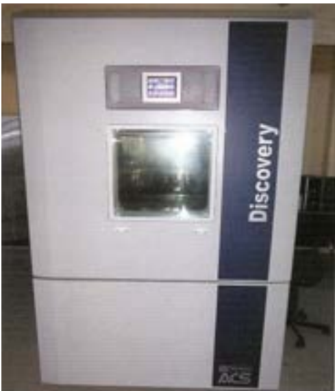
Фото 5. Климатическая камера БУ 1600С для испытаний на морозостойкость.
