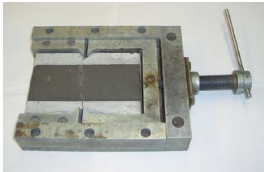
Фото 6. Общий вид прибора для определения трещиностойкости покрытия.
