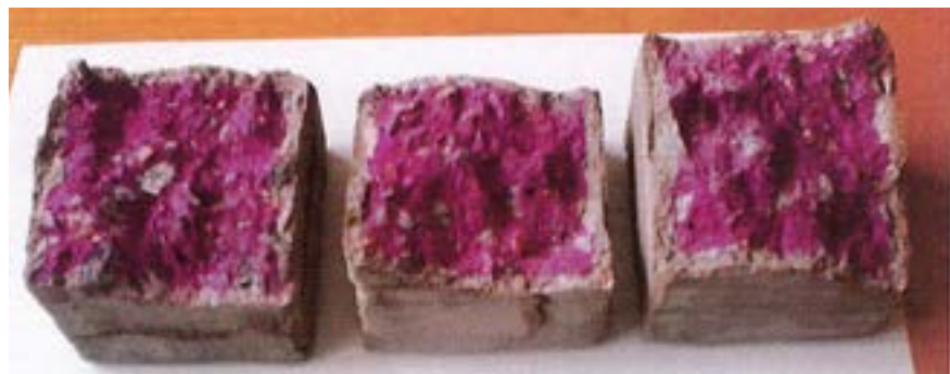
Фото 10. Внешний вид бетонных образцов с системой покрытия на основе гидроизоляционного состава Idrosilex Pronto после 7 суток испытаний
