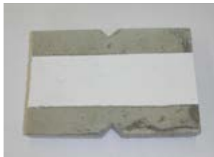
Фото 7. Внешний вид образца бетона с покрытием до испытаний на трещиностойкость.
