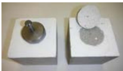
Фото 11. Внешний вид образцов бетона с системой покрытия на основе водно-дисперсионной краски Elastocolor Paint до испытаний и после испытаний на адгезию (влажный бетон).
