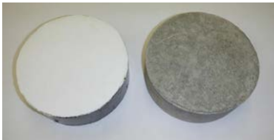
Фото 2. Внешний вид образцов с системой покрытия и на основе водно-дисперсионной краски Elastocolor Paint и контрольных образцов для испытаний на водонепроницаемость.
