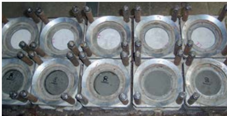
Фото 1. Установка для испытаний образцов на водонепроницаемость.
