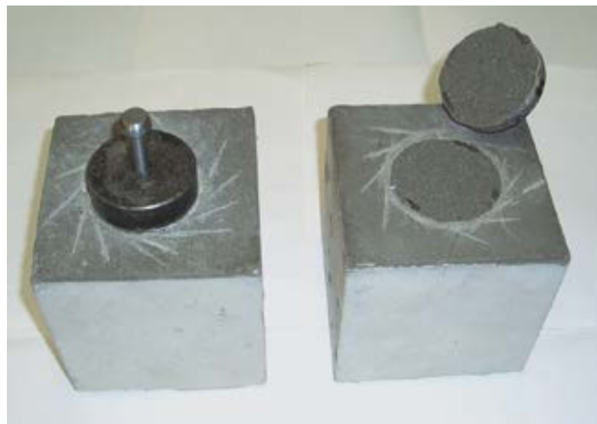
Фото 4. Внешний вид образцов бетона с покрытием Mapelastic до и после испытаний на адгезию.
