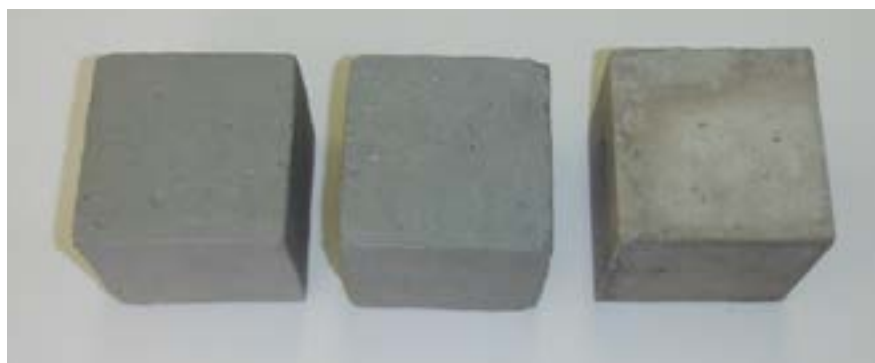
Фото 4. Внешний вид образцов перед испытаниями на морозостойкость.
