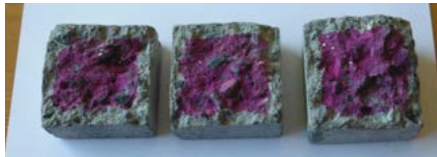
Фото 12. Внешний вид контрольных бетонных образцов (без покрытия) после 14 суток испытаний
