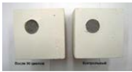
Фото 4. Характер разрушения при испытаниях на адгезию контрольных образцов и образцов после 135 циклов ускоренных климатических испытаний (покрытие Elastocolor Paint). Отрыв по телу бетонного основания; прочность сцепления покрытия с основанием больше полученного значения
