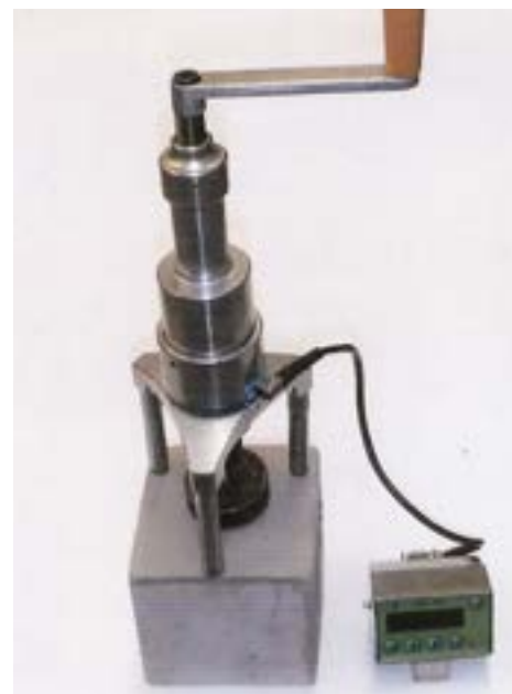
Фото 7. Измеритель прочности сцепления (адгезии) ПСО- 10МГ4.
