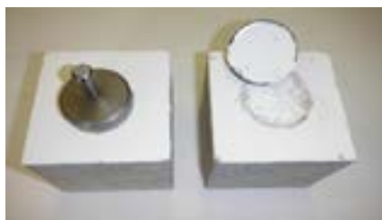
Фото 10. Внешний вид образцов бетона с системой покрытия на основе водно-дисперсионной краски Elastocolor Paint до испытаний и после испытаний на адгезию (сухой бетон).
