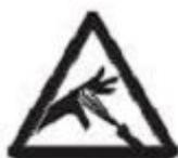
**Опасность попадания под кожу. Не распыляйте без установленного предохранителя наконечника. НИКОГДА не запускайте краскораспылитель, если наконечник не повернут полностью в положение распыления или положение очистки. ВСЕГДА активируйте блокировку пускового механизма краскораспылителя перед снятием, заменой или очисткой наконечника.**
