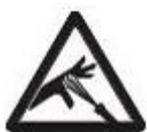
**Внимание: Опасность травмы при попадании под кожу! Поток материала под высоким давлением, создаваемый данным оборудованием, может проникнуть под кожу и в находящиеся под ней ткани, что может привести к серьезной травме и возможной ампутации.**
