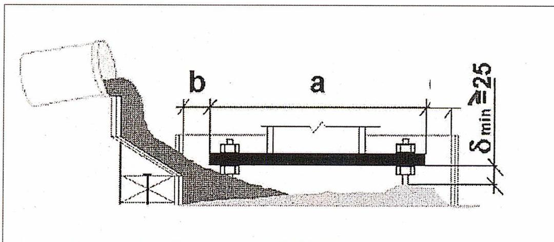
7.5. При использовании механизированной заливки, с применением растворонасосов, через отверстия подачи в опорной плите, необходимо при заливке соблюдать последовательность
