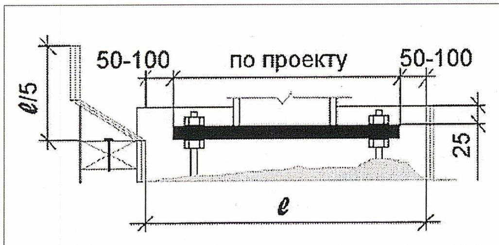
3.6. Если заливка только с одной стороны (с условием, что раствор «дотечет» до противоположной стороны) невозможна, ввиду большой площади опорной плиты и заполняемой полости, то следует устраивать отверстия для выпуска воздуха и для подачи раствора.
