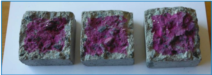
Рис. 13. Внешний вид контрольных бетонных образцов (без покрытия) после 14 суток испытаний
