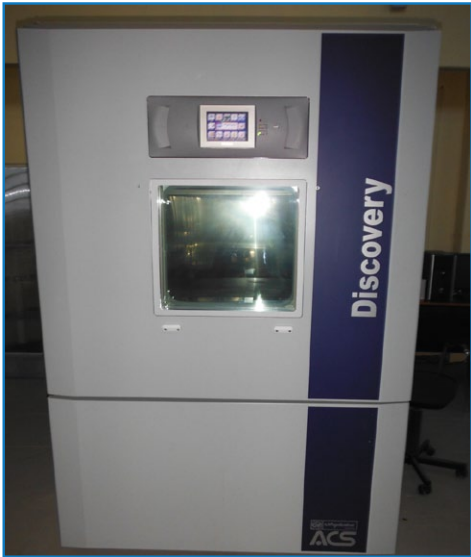
Рис. 3. Климатическая камера DV 1600C для испытаний на морозостойкость.
