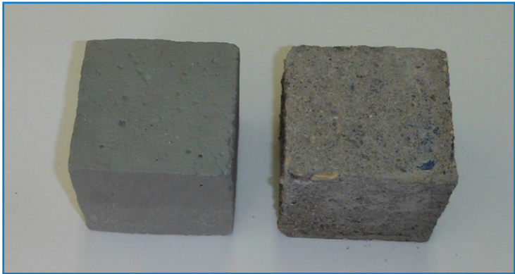
Рис. 5. Внешний вид образцов после 5 циклов испытаний на морозостойкость.
