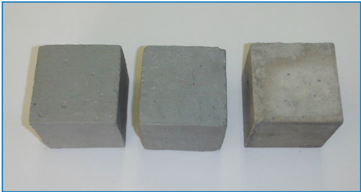
Рис. 4. Внешний вид образцов перед испытаниями на морозостойкость.
