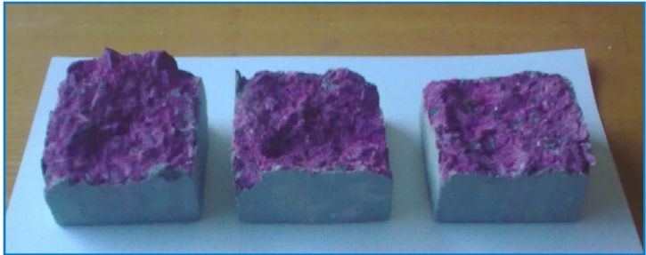
Рис. 13. Внешний вид бетонных образцов с системой покрытия «COLORITE BETON» после 14 суток испытаний
