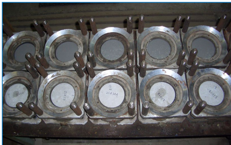
Рис. 1. Установка для испытаний образцов на водонепроницаемость.
