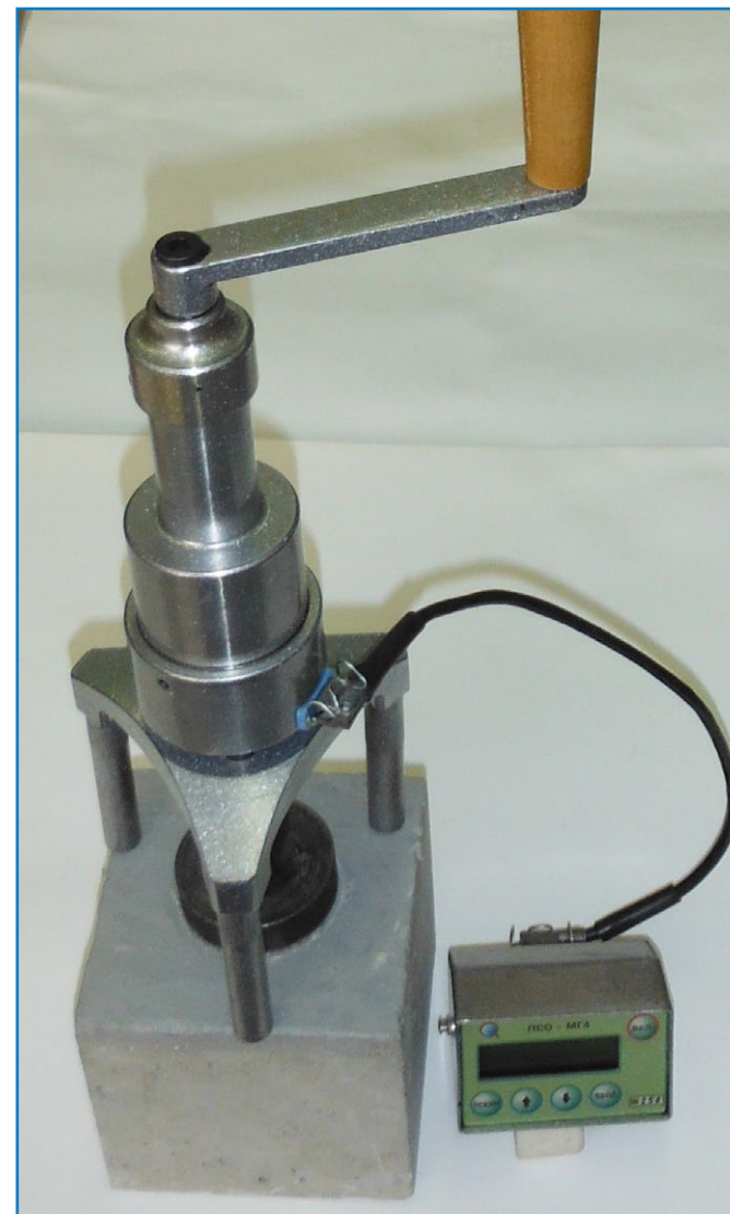
Рис. 9. Измеритель прочности сцепления (адгезии) ПСО-10МГ4.
