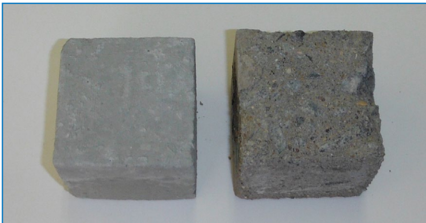
Рис. 6. Внешний вид образцов после 10 циклов испытаний на морозостойкость.
